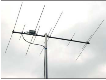
Bild 4: Die erweiterte Vierelement-Yagi mit den 70-cm-Elementen
