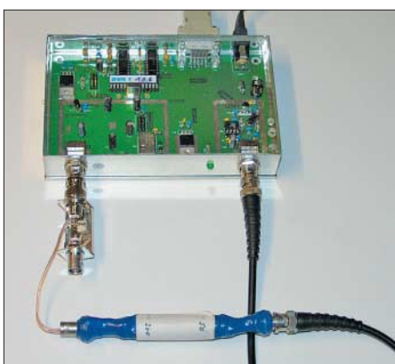
Bild 7: 1:4-Balun auf einem Mittelwellen-Ferritstab für die Verwendung mit einer Magnetantenne
