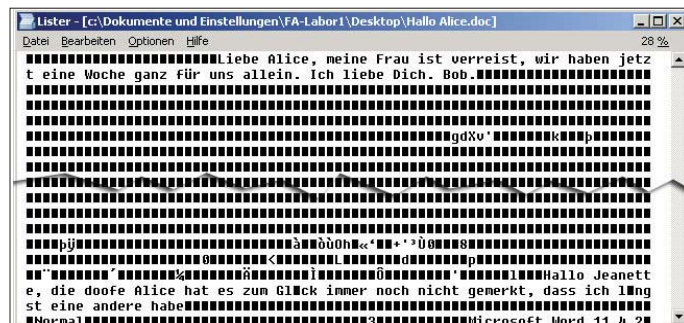
Bild 2: In Word erscheint nur der obige Text, doch der Total Commander oder ähnliche Programme offenbaren auch den in derselben Datei zuvor geschriebenen, abgespeicherten und wieder gelöschten Text unten ...
