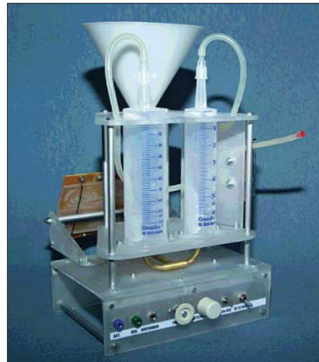
Bild 3: Zwei Tanks speichern den durch die Brennstoffzelle erzeugten Sauerstoff und Wasserstoff. Fotos: Bindhammer (2), Frankh-Kosmos Verlag (1)
