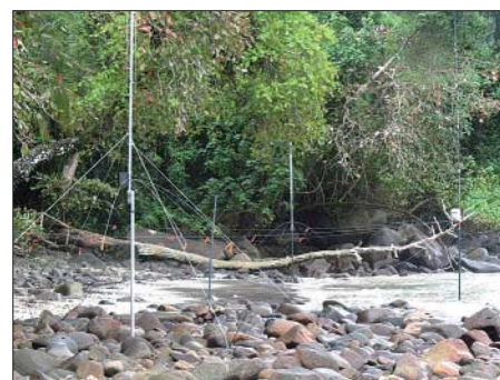
Die Vertikalantennen im Küstenbereich, aufgebaut bei Ebbe; die Wellen spritzten oft bis zu den Radials hoch und veränderten die Stehwellenverhältnisse spürbar.
