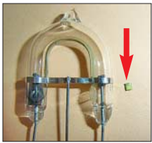
Bild 1: Die kleine Blitz-LED LXCL-PWF3 gibt die gleiche Helligkeit ab wie eine Xenon-Blitzröhre.
