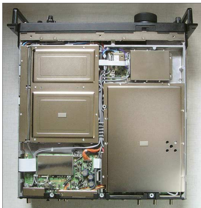
Bild 3: Ansicht von oben in das geöffnete Gerät; links oben die spezielle Lautsprecherbox, links der Antennentuner und in der Mitte die Endstufe mit ihren beiden Lüftern
