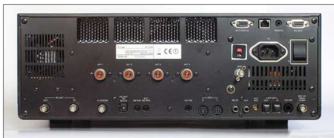
Bild 2: Die Rückfront des IC-7700 wirkt trotz der vielen Buchsen dank ihrer Größe recht aufgeräumt. Die Beschriftung ist auch bei ungünstiger Beleuchtung gut zu lesen – durchaus nicht selbstverständlich ...
