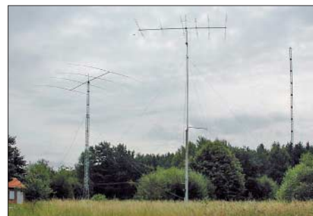
Das QTH in Horschlitt mit Vierelement-40-m-Beam, KT34XA und Gittermast für 160 m Fotos: DA0HQ
