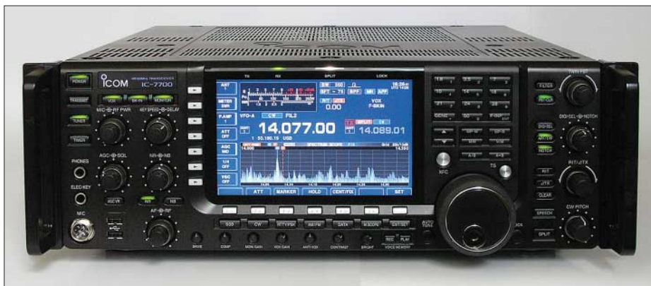
Bild 1: Diese Ansicht lässt nicht nur die Frontplattengröße des IC-7700 erkennen, sondern auch seine erhebliche Tiefe. Fotos und Screenshots: DJ1TO
