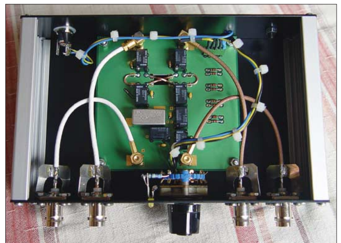
Bild 2: Innenansicht der betriebsfertigen Box; die Massebügel an den Buchsen sind über den FA-Leserservice erhältlich.
