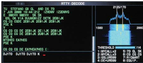
Bilder 8 und 9: Mit dem IC-7700 ist eigenständiger RTTY- und PSK-Betrieb möglich. Eine USB-Tastatur und je acht Text- speicher helfen beim Senden.
