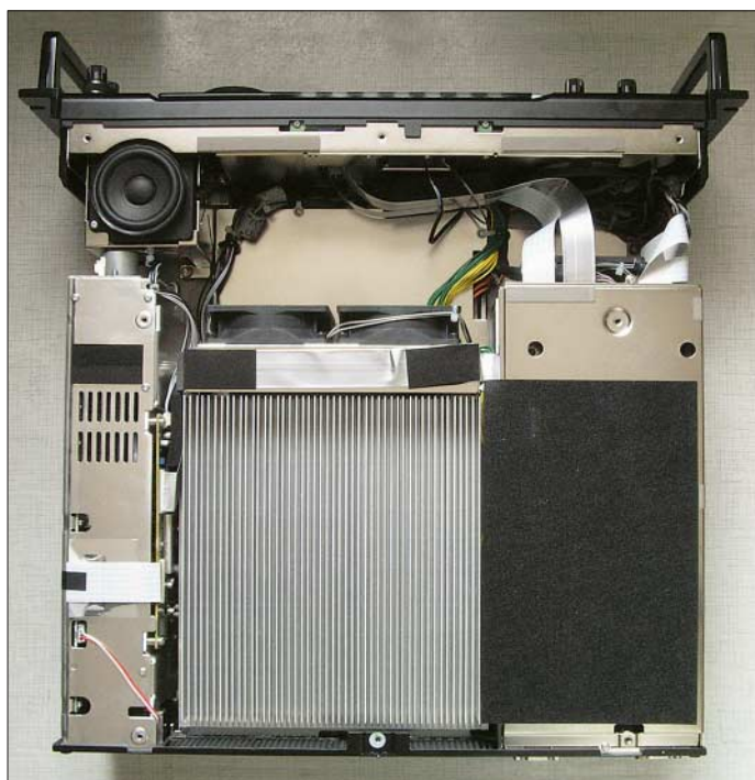
Bild 4: Innenansicht von unten; die meisten Baugruppen sind akkurat geschirmt; oben in der Mitte das Herz der exquisiten Frequenzstabilität, der Quarzofen
